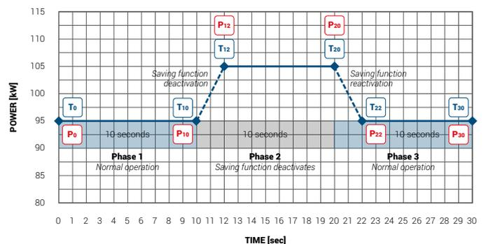
Die Gesamtenergieeinsparung während des Tages ist die Summe der Einzelmessungen, die das Verfahren des IPMVP-Protokolls 96 Mal pro Tag wiederholen und die Anforderungen der VDE-Norm übertreffen, indem sie Probe für Probe die Änderung des Lastmixes abfangen. Die Garantie von Enersolve, dank dieser ESPRO-Funktionalität, bezieht sich auf die Gesamteinsparung in kWh.
